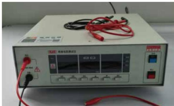
绝缘电阻测试器—测试产品表体是否漏电
