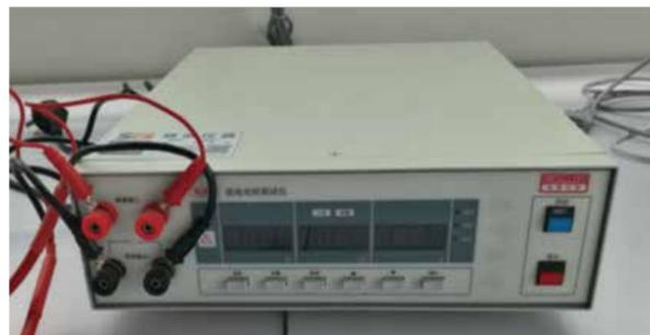
接地电阻测试器—用于检测产品保护接地防止漏电
