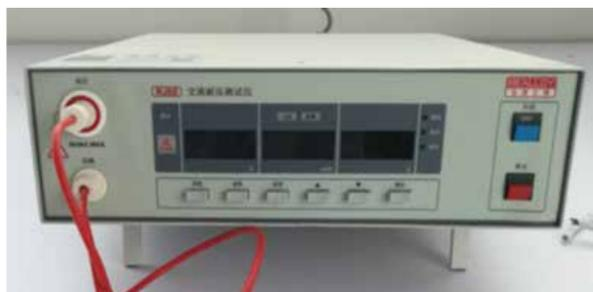
耐压测试器—检测产品在瞬间高压时的特性
