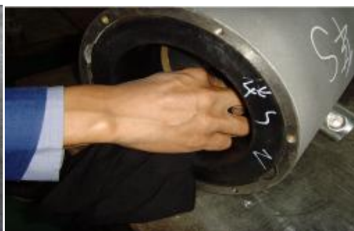
图6 清理制动器内部
