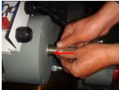
图 3 柱塞的灵活度检查
