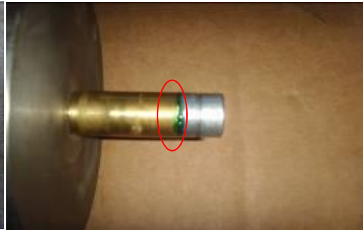
图 10 胶水溢出示意图
