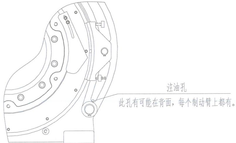
注意：当曳引机在抱闸过程中，如出现制动器打不开，或者抱闸抱不住的情况。请在此处加润滑油，并在转动制动臂的时候无卡滞现象。
