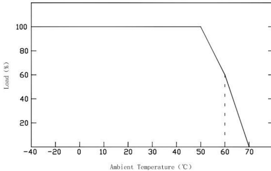
※为了延长电源的寿命，请参照降额曲线降低温度
