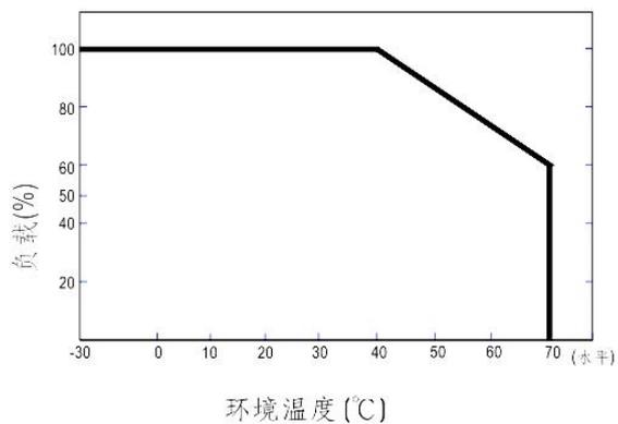
※请按照负载减额曲线, 根据环境温度减额所带负载, 以延长使用寿命
