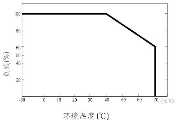
※请按照负载减额曲线, 根据环境温度减额所带负载, 以延长使用寿命
